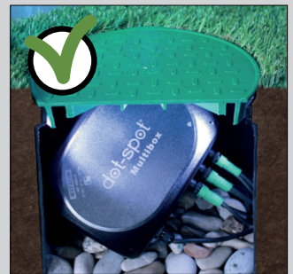
Netzteil in Elektrogehäuse, erhöht eingelegt, Drainage für Bodenschacht vorsehen Power supply inside electrical housing, inserted in elevated position, drainage for ground shaft Bloc d'alimentation dans boîtier électrique, inséré en position élevée, drainage pour boîte de sol
